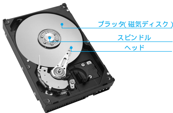
ハードディスクの内部構造
